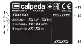
Beispiel Typenschild des Motors
